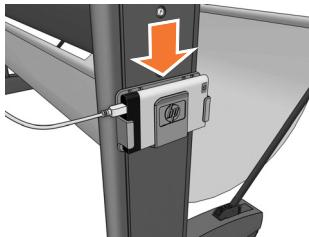
3. 将 USB 电缆连接到外接硬盘上。
