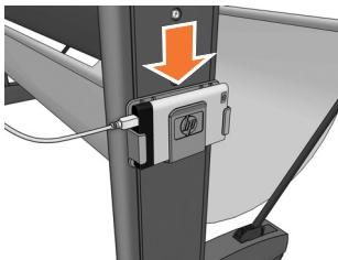
3. Conecte o cabo USB ao disco rígido externo.
