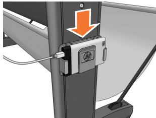
3. Conecte el cable USB al disco duro externo.
