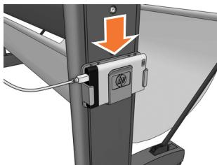
3. Sambungkan kabel USB ke hard disk eksternal.
