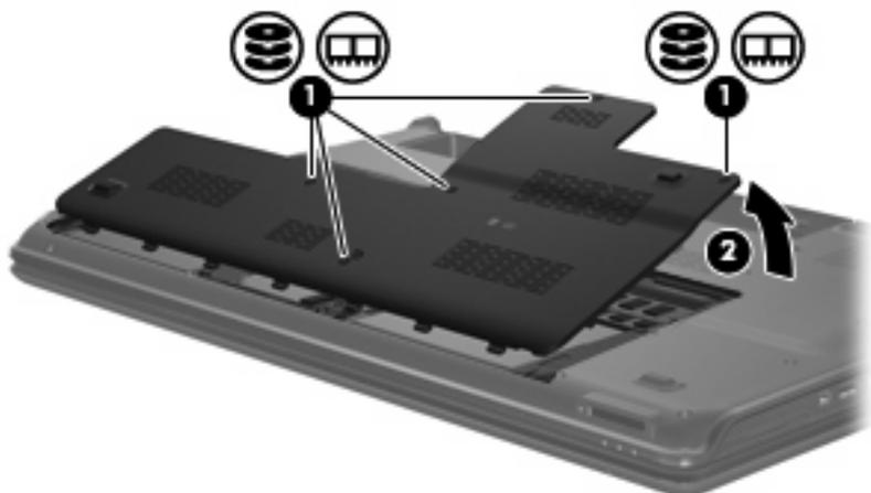
9. メインメモリモジュールスロットのメモリモジュールをアップグレードするか、空いている拡張メモリモジュールスロットにメモリモジュールを追加する場合は、まず、以下の要領で既存のメインメモリモジュールを取り外します。
