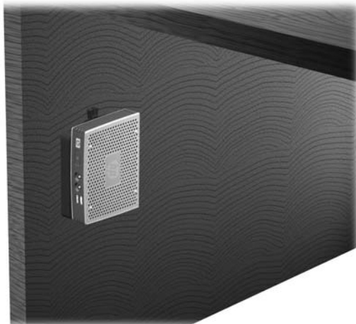
Figure C-8 Client léger installé sous un bureau
