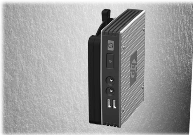
Figura C-7 Thin client montado en la pared
