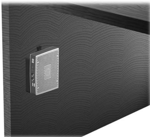
Figura C-8 Thin client montado bajo el escritorio
