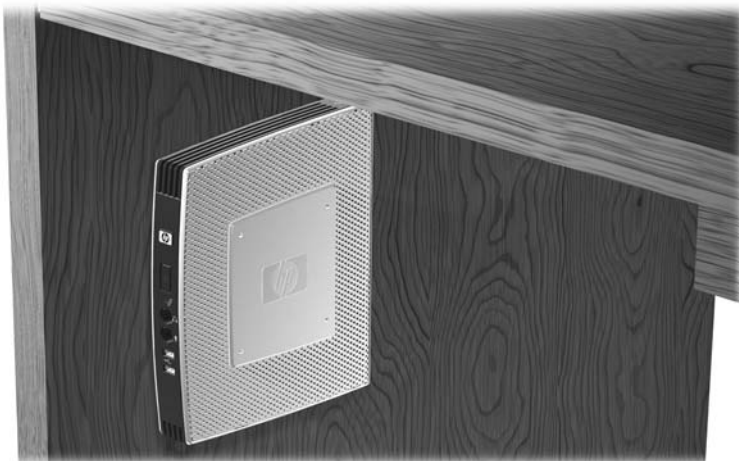
Figure C-8 Client léger installé sous un bureau
