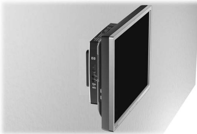
Figura C-5 Thin client montato con schermo piatto a parete
