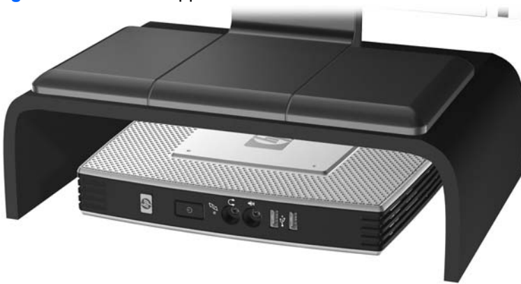
Figura D-3 Sotto il supporto del monitor
