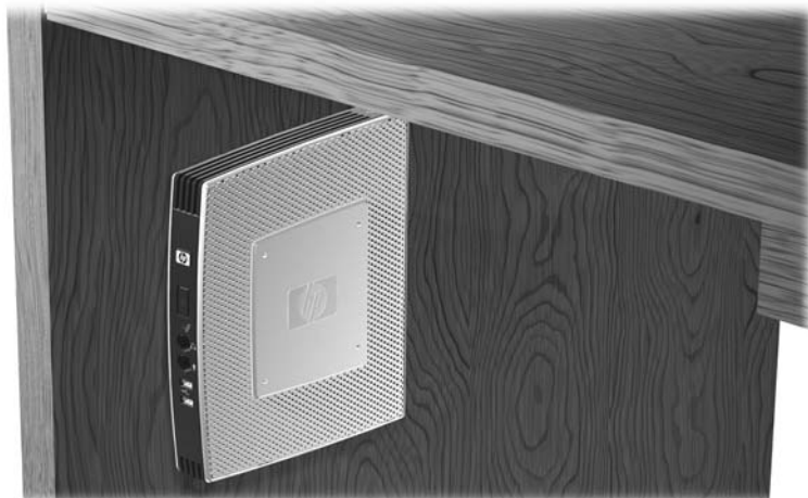
Figura C-8 Thin client montado embaixo da mesa
