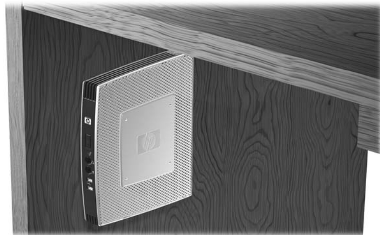
圖示 C-8 安裝在書桌下的精簡型電腦
