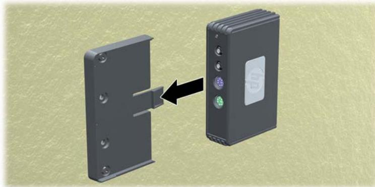
2. Sostenga el HP MultiSeat Thin Client t100 para que la parte inferior de la unidad esté junto al Soporte para Montaje, y deslice primero la parte frontal del HP MultiSeat Thin Client t100 en el soporte.
