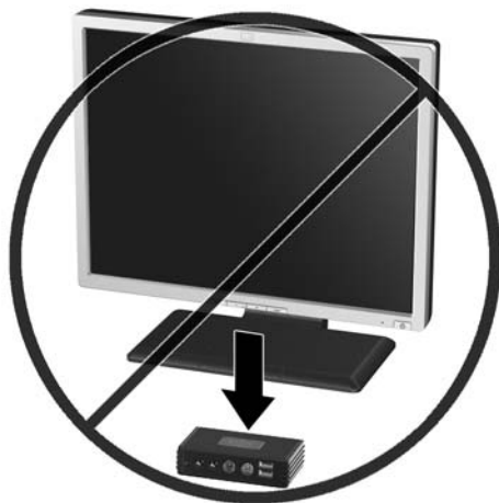
Figura D-4 Não coloque um monitor sobre o HP MultiSeat Thin Client t100
