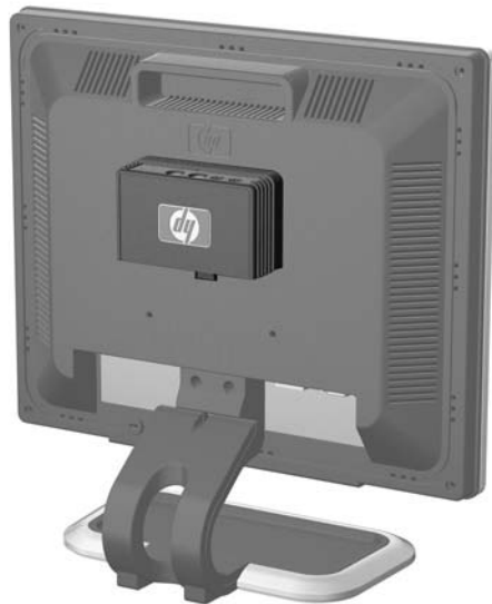
圖示 C-5 裝載於顯示器背面的 HP MultiSeat Thin Client t100
