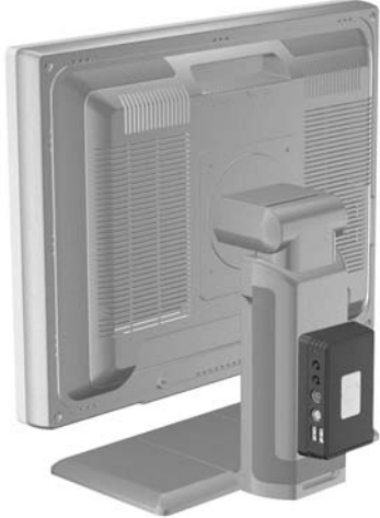
圖示 C-4 裝載於顯示器機座背面的 HP MultiSeat Thin Client t100
