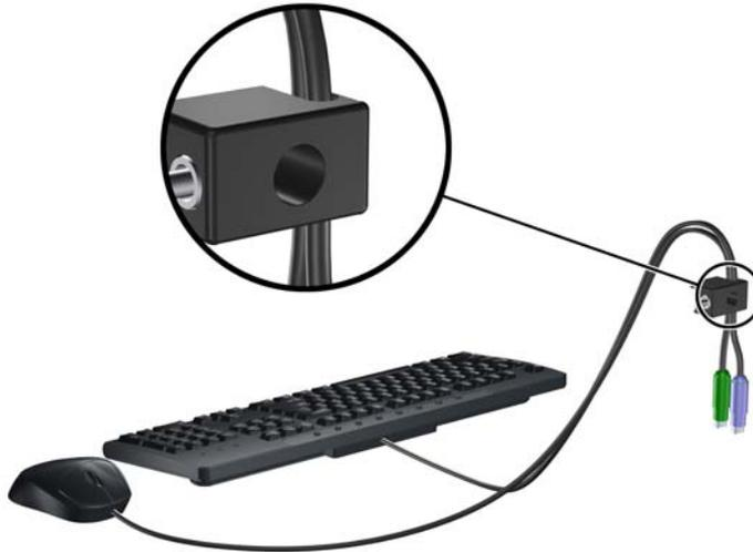
3. Schrauben Sie das Schloss mit der beigefügten Schraube am Gehäuse fest.
