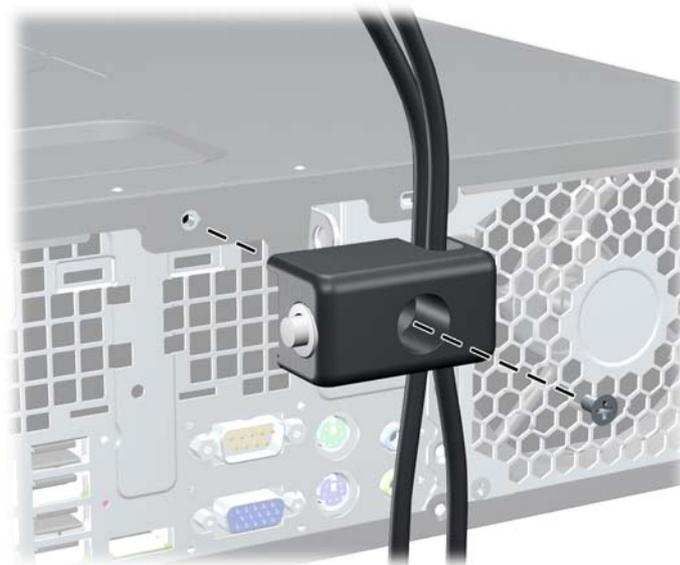
4. Führen Sie den Stecker des Sicherheitskabels in das Schloss ein (1), und drücken Sie den Knopf hinein (2), um das Schloss zu aktivieren. Verwenden Sie den beiliegenden Schlüssel, um das Schloss zu öffnen.
