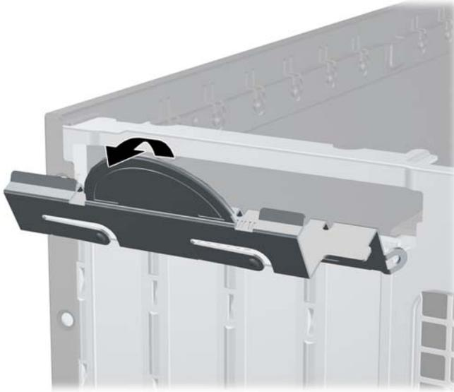
9. Entfernen Sie vor dem Einsetzen einer Erweiterungskarte die Steckplatzabdeckung bzw. eine bereits vorhandene Erweiterungskarte.
