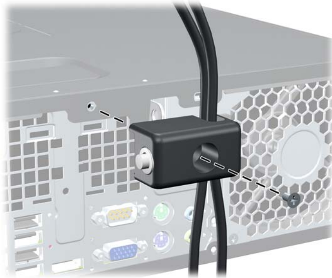
Figure C-5 Fixation du verrou sur le châssis
