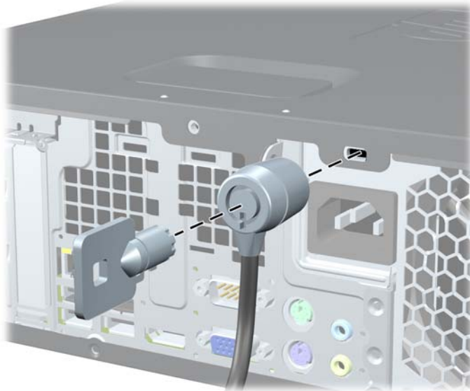
Figure C-1 Installation d'un câble de sécurité
