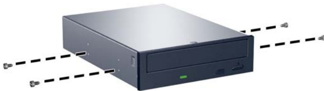
Figure 2-24 Installation des vis de guidage dans l'unité optique
