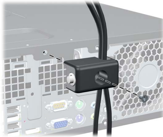
Figura C-5 Sujeción del candado al chasis
