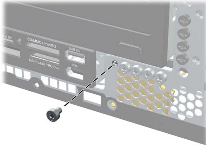
Figura C-7 Recuperación del tornillo de seguridad del panel frontal
