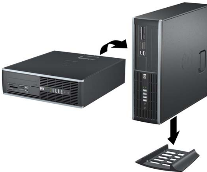
Figura 2-6 Cambio de la orientación de escritorio a torre
