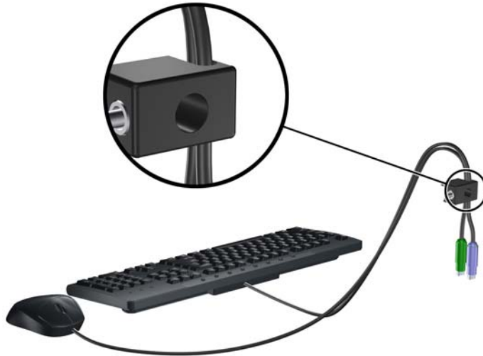
Figura C-4 Enroscado de los Cables del Teclado y del Mouse
