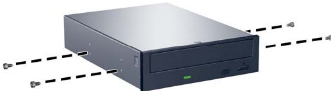
Figura 2-24 Instalación de tornillos guía en la unidad óptica
