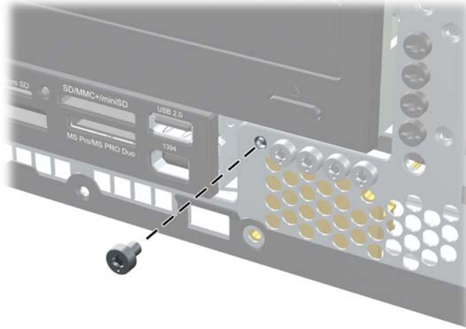
Figura C-7 Extracción del Tornillo de Seguridad del Panel Frontal
