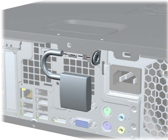
Figura C-2 Instalação de um cadeado
