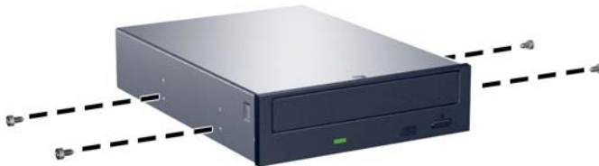
Figura 2-24 Instalação dos parafusos-guia na unidade óptica
