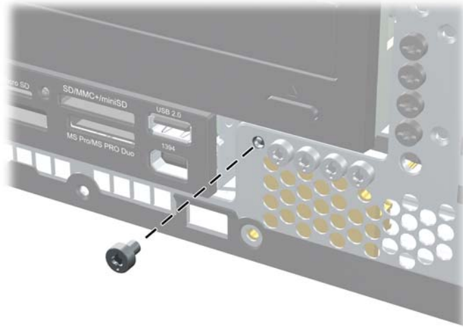
Figura C-7 Recuperação do Parafuso de Segurança no Painel Frontal
