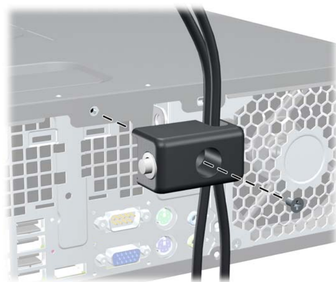
图 C-5 将钳锁固定到机箱上
