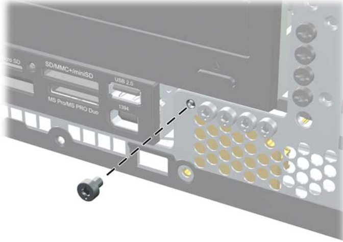
图 C-7 获取前面板安全保护螺钉
