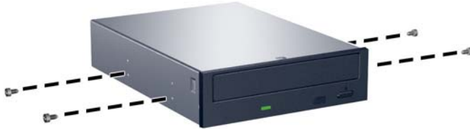
图 2-24 在光驱中安装导向螺钉
