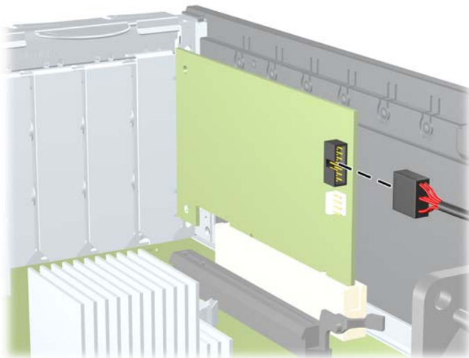
图 2-30 断开介质卡读卡器 1394 电缆
