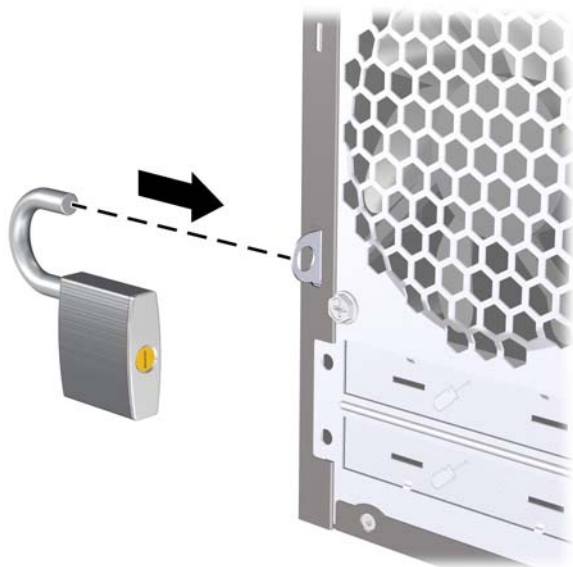
Figura C-2 Instalación de un candado
