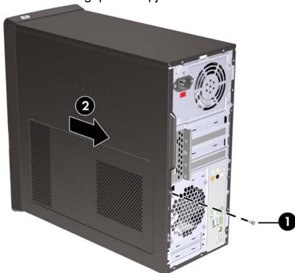
2-1 ábra A számítógép oldallapjának eltávolítása
