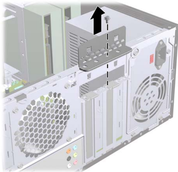
2-9 ábra A takarólemezek rögzítőelemének kinyitása
