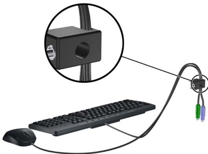
Рисунок С-4 Просування кабелів клавіатури і миші
