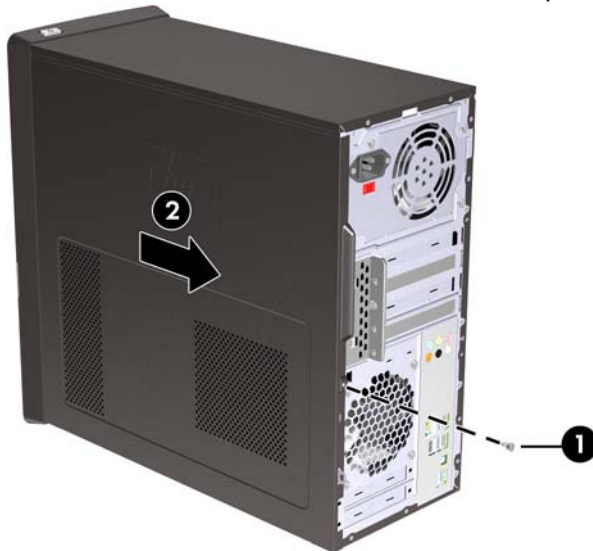
Рисунок 2-1 Видалення знімної панелі комп'ютера
