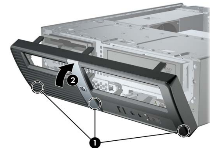
Figure 5 Remise en place du panneau avant
