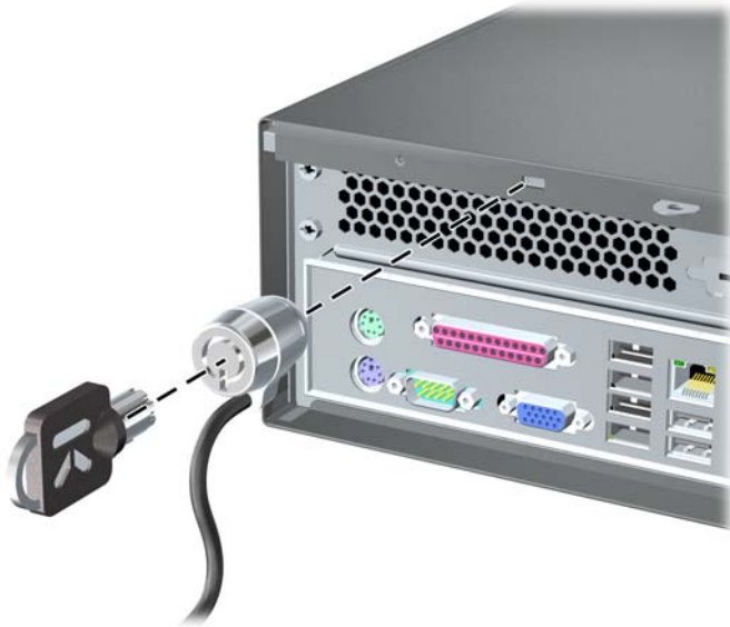
Figure 40 Installation d'un verrou de câble
