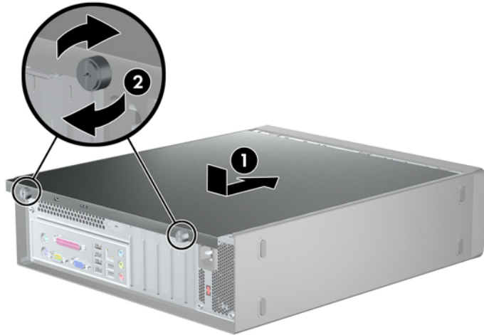
Figure 2 Remise en place du panneau d'accès
