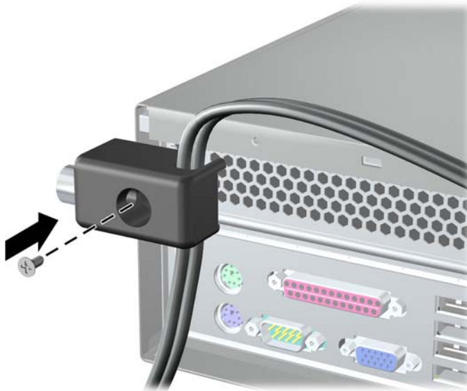
Figure 44 Fixation du verrou au châssis
