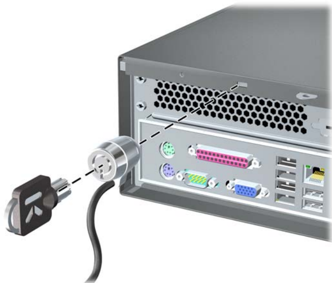
Figura 40 Instalación de un candado con cadena
