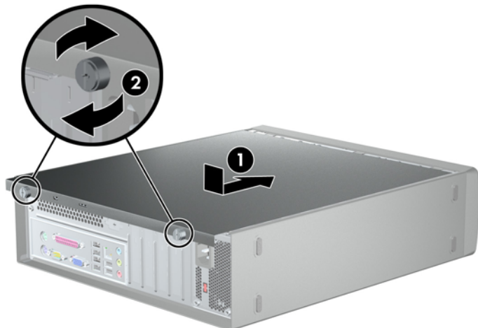
Figura 2 Sustitución del panel de acceso
