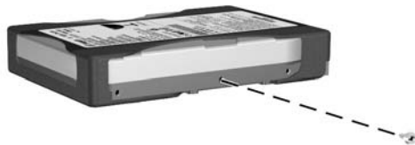
Figura 33 Instalación del tornillo de guía en la unidad de disco duro
