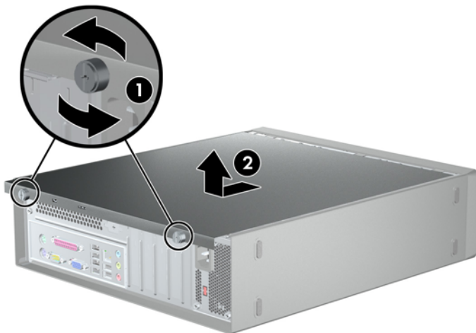
Figura 1 Extracción del panel de acceso
