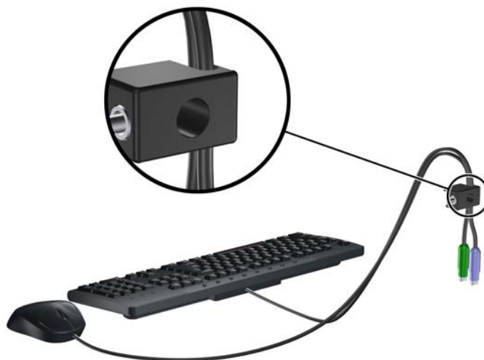
図 43 キーボードとマウスのケーブルによる固定
