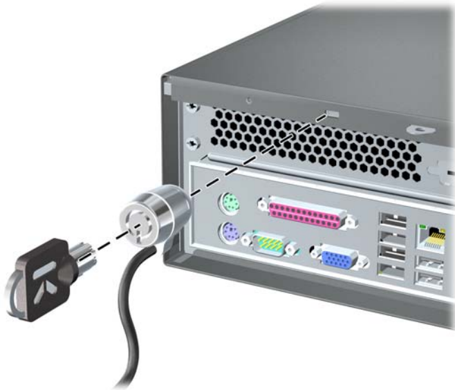
図 40 ロック ケーブルの取り付け
