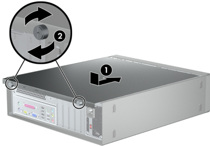
Gambar 2 Memasang Kembali Panel Akses
