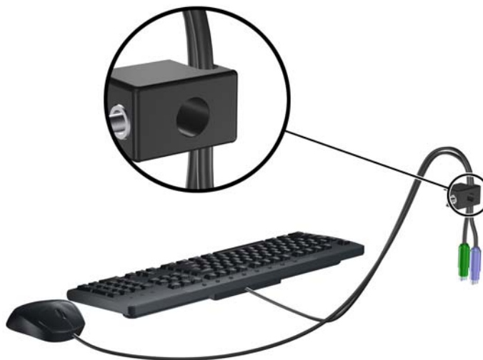
Gambar 43 Memasukkan Kabel Keyboard dan Mouse
