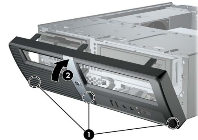
Gambar 5 Memasang Kembali Bezel Depan
