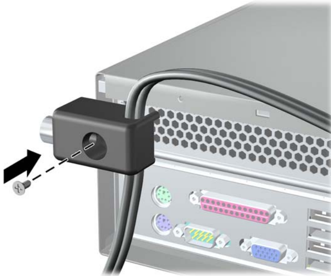
Gambar 44 Memasang Kunci pada Chassis
