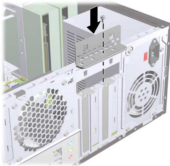
Abbildung 12 Befestigen von Erweiterungskarten und Steckplatzabdeckungen
