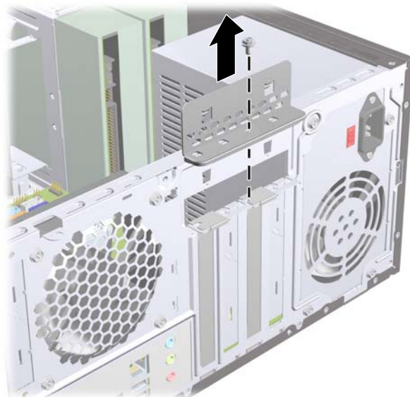
Abbildung 7 Öffnen der Steckplatzverriegelung
