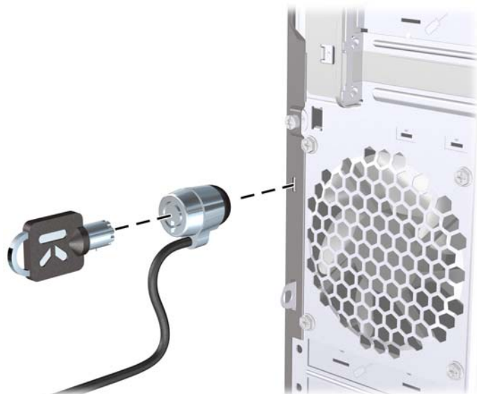
Abbildung 33 Installieren eines Sicherungskabels
