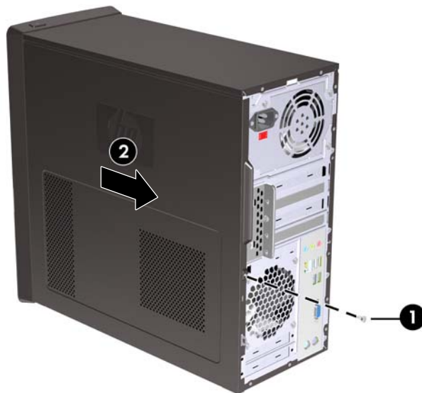
Figura 1 Extracción del panel de acceso del ordenador
