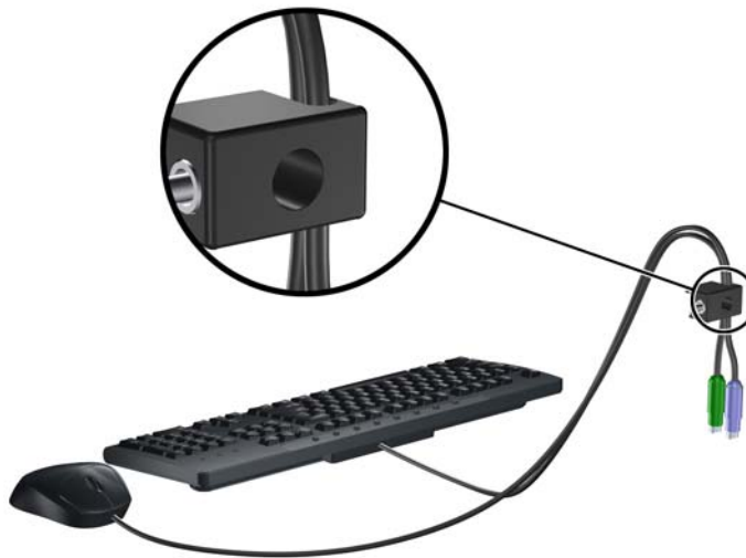
Figura 36 Sujeción de los cables del teclado y del ratón
