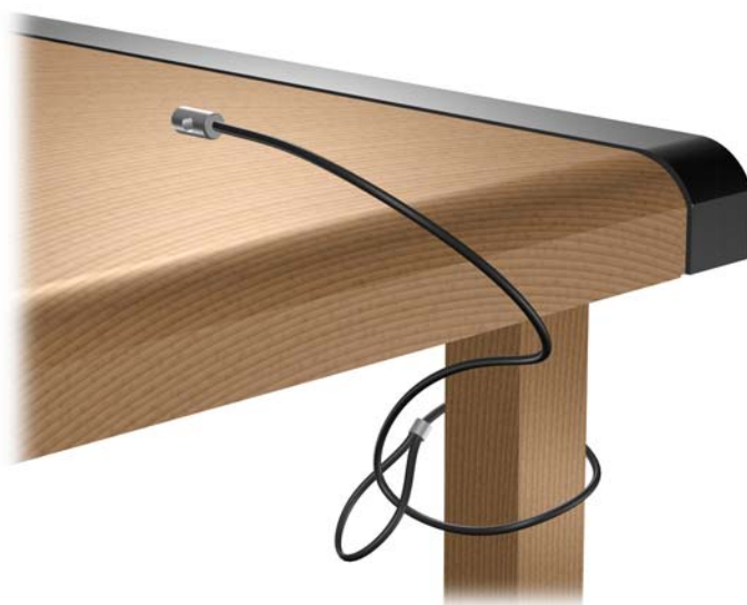
Figura 35 Acoplado del Cable a un Objeto Fijo
