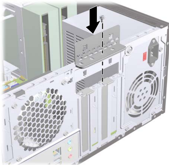
Figura 12 Fijación de Tarjetas de Expansión y Cubiertas de Ranura
