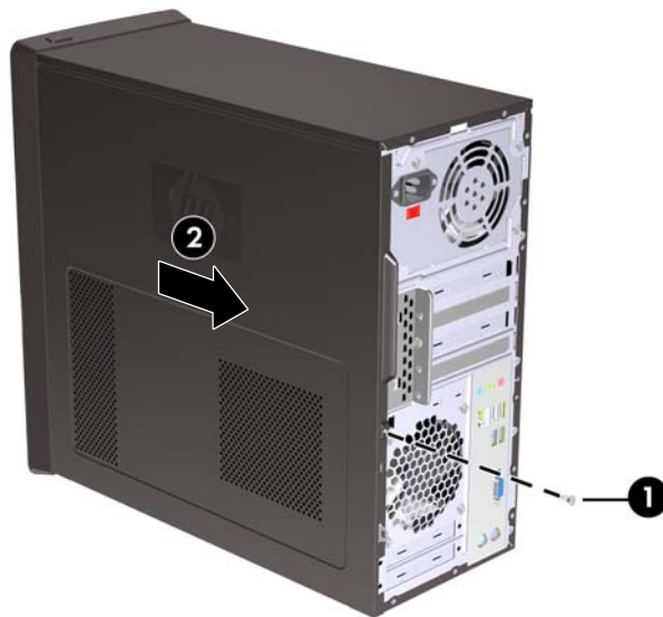
Figura 1 Extracción del Panel de Acceso de la Computadora
