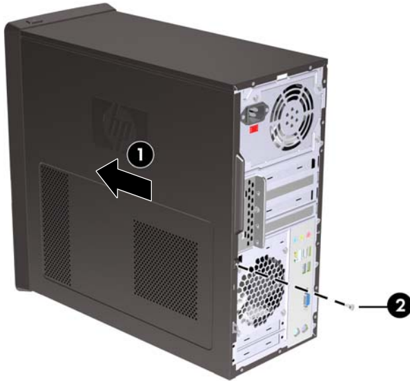
Figura 2 Reinstalación del Panel de Acceso de la Computadora
