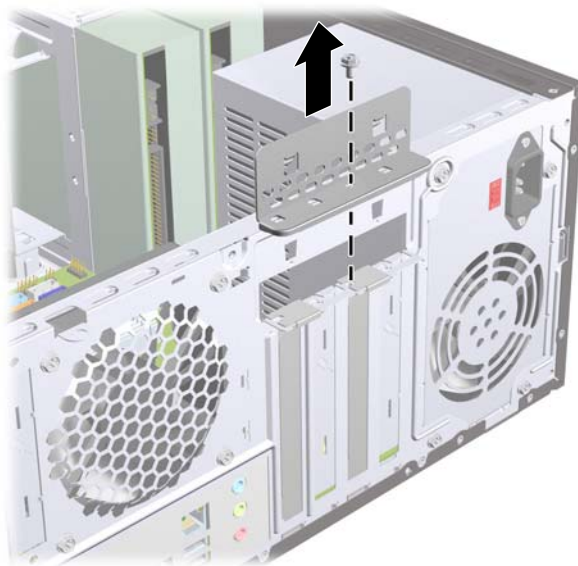
Figura 7 Apertura del Bloqueo de Cubierta de Ranuras
