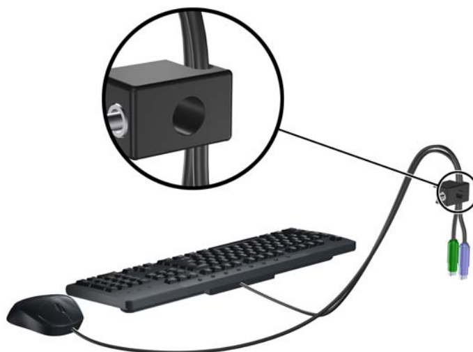
Figura 36 Enroscado de los Cables del Teclado y del Mouse
