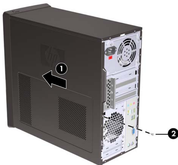
Obrázok 2 Založenie prístupového panela počítača
