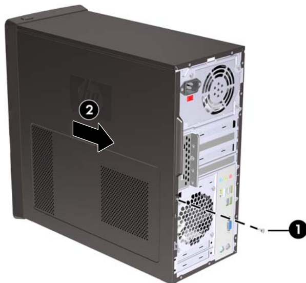
Obrázok 1 Odstránenie prístupového panela počítača
