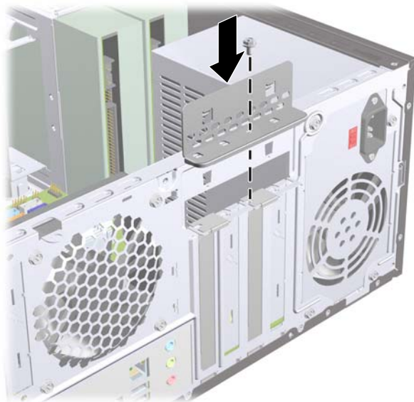
Slika 12 Odstranitev razširitvenih kartic in pokrovov rež
