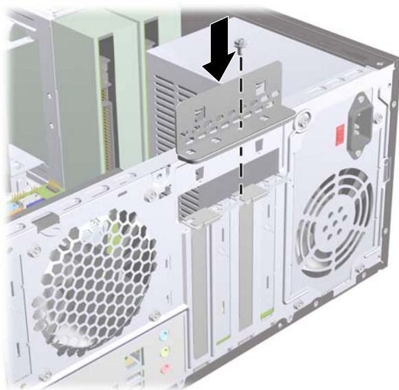
Slika 12 Pričvršćivanje kartica za proširenje i poklopca utora
