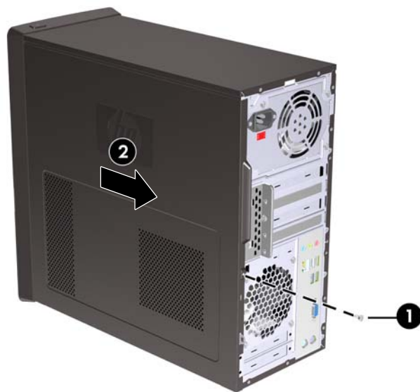
Slika 1 Uklanjanje pristupne ploče računara
