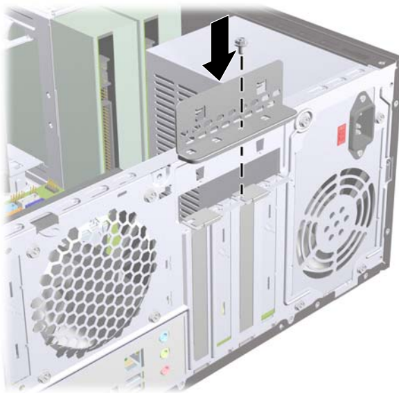
Slika 12 Učvršćivanje kartica za proširenje i poklopaca za utor
