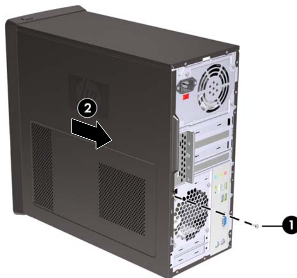
Joonis 1 Arvuti külgpaneeli eemaldamine
