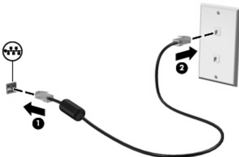
△ **警告!** 火傷や感電、火災、装置の損傷を防ぐため、モデム ケーブルまたは電話ケーブルを RJ-45 (ネットワーク) コネクタに接続しないでください。
