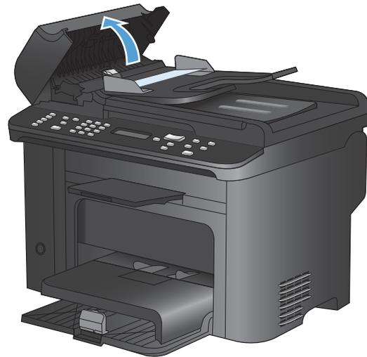
2. Heben Sie den Seitenhebel an, um die Einzugsseinheit zu öffnen, und ziehen Sie vorsichtig das gestaute Papier heraus.
