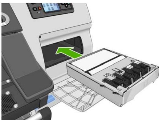
3. Une fois que la cartouche de nettoyage des têtes d'impression a été insérée à fond, appuyez vers l'intérieur et vers le bas tel qu'indiqué pour l'enclencher en position.
