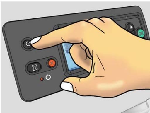
Lorsque vous mettez l'imprimante hors tension de cette manière, les têtes d'impression sont automatiquement rangées avec la cartouche de nettoyage des têtes d'impression pour éviter qu'elles sèchent.
