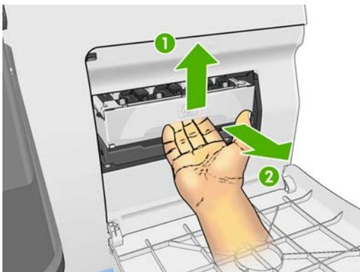
4. Levante o cartucho de limpeza de cabeçotes de impressão para removê-lo do slot e deslize-o para fora.
