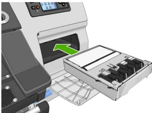
3. Quando o cartucho de limpeza de cabeçotes de impressão tiver sido totalmente introduzido, pressione-o para dentro e para baixo, conforme indicado, até que ele trave no local adequado.
