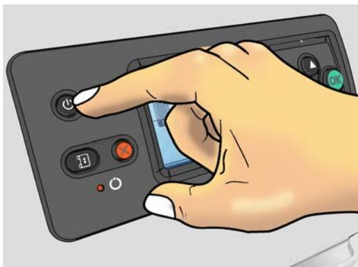
Quando você desliga a impressora dessa forma, os cabeçotes de impressão são automaticamente armazenados com o cartucho de limpeza de cabeçotes de impressão, o que previne que eles sequem.
