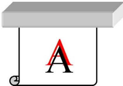
색상이 어떤 방향으로든 잘못 정렬되는 경우 프린트 헤드가 잘못 정렬되었을 수 있습니다. 프린트 헤드를 오랫동안 정렬하지 않았거나 인쇄물 걸림이 있었던 경우 이런 문제가 발생할 수 있습니다. 필요한 경우 프린트 헤드를 정렬합니다([11페이지의프린트 헤드 정렬](#) 참조). 프린트 헤드 상태 플롯을 사용하여 정렬해야 하는지 여부를 확인할 수 있습니다([22페이지의프린트 헤드 상태 플롯 사용](#) 참조).
