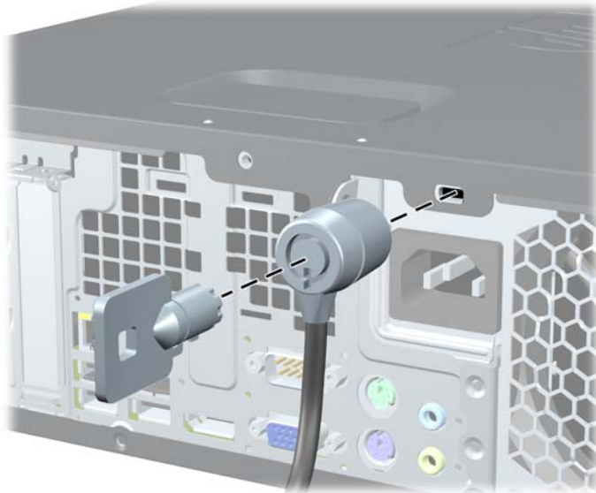
Figure C-1 Installation d'un câble de sécurité
