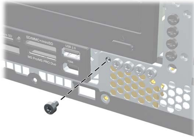
Figure C-7 Réinstallation de la vis de sécurité du cache avant
