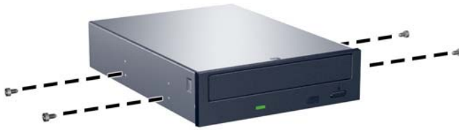
Figure 2-25 Installation des vis de guidage dans l'unité optique
