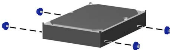
Figure 2-38 Installation des vis de guidage de disque dur
