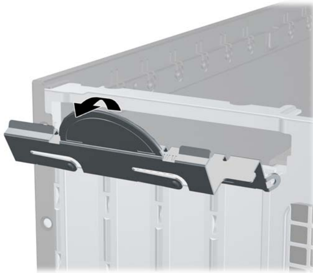
Figure 2-12 Ouverture du dispositif de retenue
