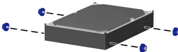
Figura 2-38 Instalar parafusos-guia da unidade de disco rígido
