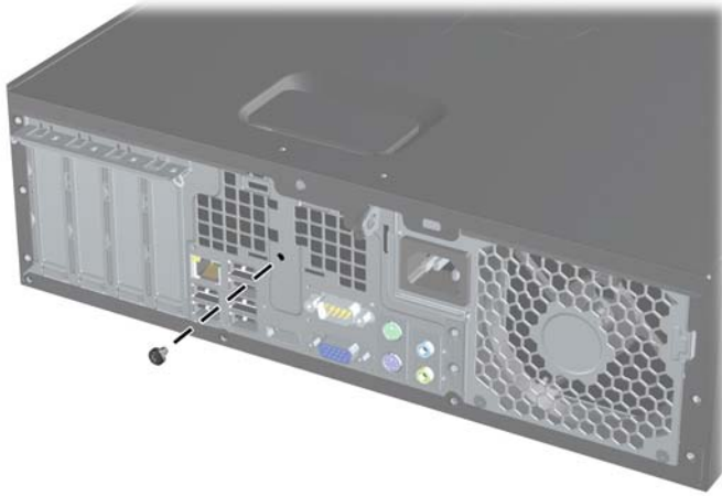
Figura 2-1 Retirar o parafuso do Smart Cover Lock
