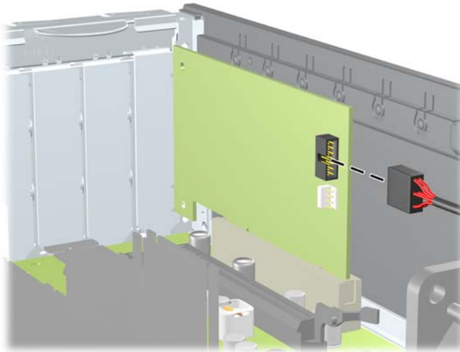
Figura 2-31 Desligar o cabo 1394 do leitor de cartões multimédia
