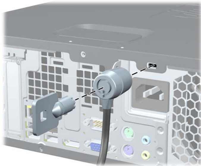
Figura C-1 Instalar um cadeado de cabo
