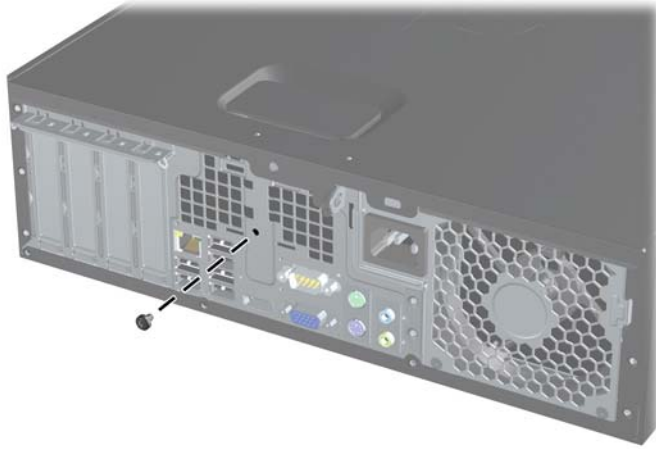
Figura 2-1 Extracción del Tornillo del Bloqueo Inteligente de Cubierta
