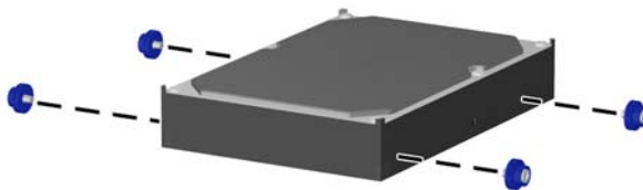
Figura 2-38 Instalación de los Tornillos Guía en la Unidad de Disco Duro
