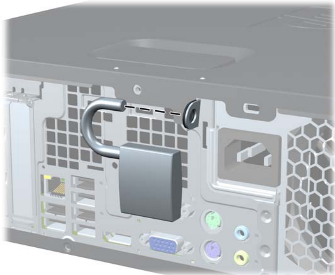
Figura C-2 Instalación de un candado
