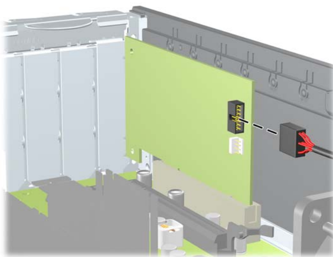
Рисунок 2-31 Отсоединение кабеля 1394 устройства чтения карт памяти
