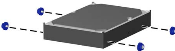
Рисунок 2-38 Установка направляющих винтов жесткого диска
