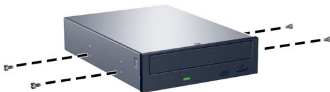
Рисунок 2-25 Установка направляющих винтов оптического дисковода
