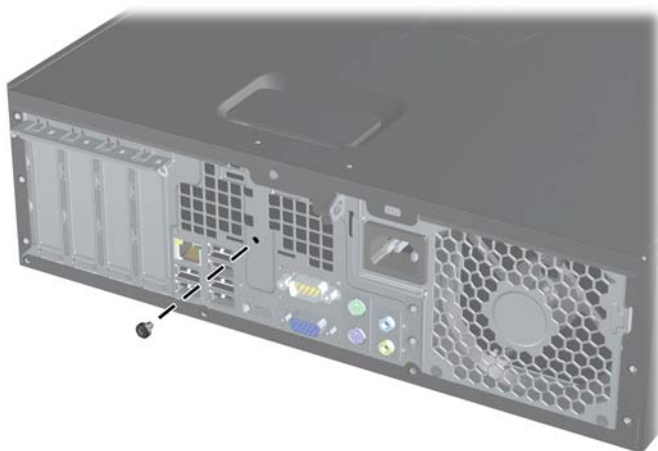
Рисунок 2-1 Снятие винта блокировки крышки
