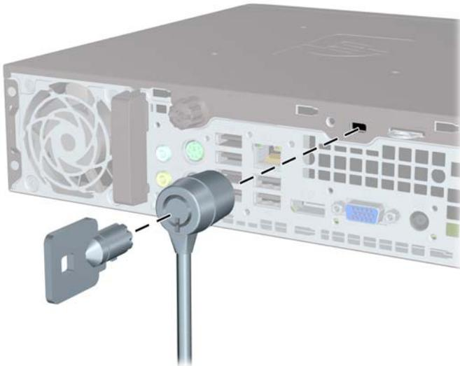
**Abbildung C-2** Anbringen einer Kabel-Diebstahlsicherung mit installierter Anschlussabdeckung
