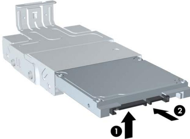
13. Posez le disque dur dans la partie inférieure du support (1), puis replacez les quatre vis de guidage sur les côtés pour maintenir le disque dans le support (2).
