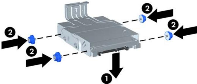
14. Pour remplacer le support du disque dur dans le châssis, alignez les vis de guidage avec les connecteurs du compartiment de disque, lâchez le support dans le compartiment (1) et appuyez sur le levier du support jusqu'au fond (2) de façon à ce que l'unité soit parfaitement maintenue en place.
