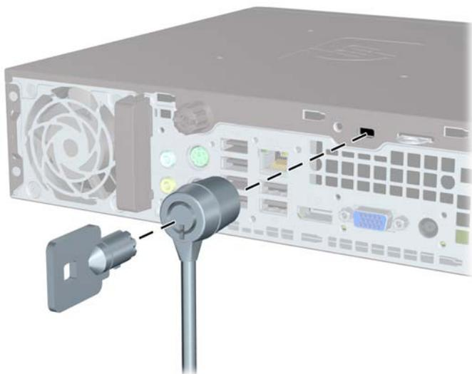
**Figure C-2** Installation d'un câble avec un cache de port
