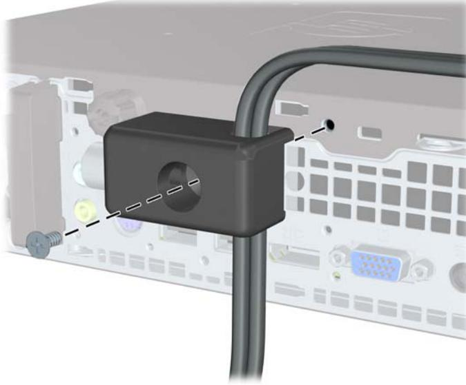
4. Insérez la prise du câble de sécurité dans le verrou (1) et enfoncez le bouton (2) pour fermer le verrou. Utilisez la clé fournie pour ouvrir le verrou.
