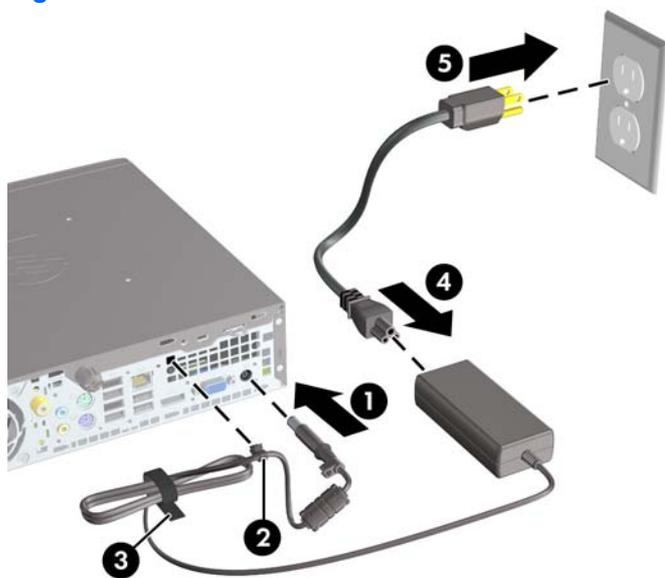
△ **ATTENTION :** Si vous ne sécurisez pas le câble d'alimentation à l'aide du dispositif de retenue, le cordon d'alimentation peut se débrancher et entraîner la perte de données.
