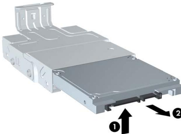
12. Positionnez le disque dur de manière à ce que sa partie supérieure se trouve contre la partie supérieure du support (1) afin que la carte de circuit intégré qui se trouve sous le disque dur n'entre pas en contact avec les languettes de la partie inférieure du support, puis faites glisser le nouveau disque dur dans le support (2).
