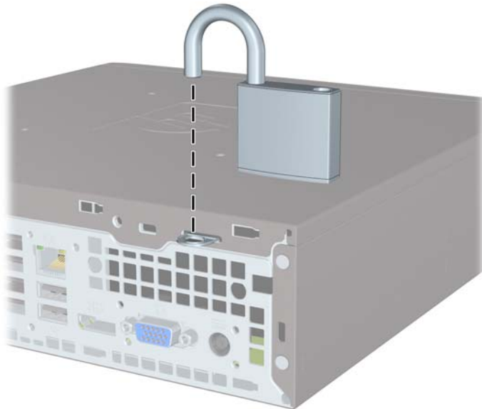
Bild C-3 Installera ett tangentbordslås
