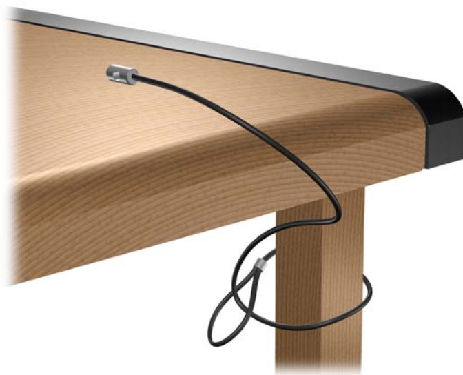
Bild C-4 Fästa kabeln i ett fast objekt
