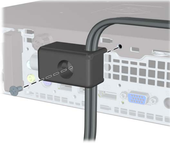
Bild C-6 Skruva fast låset i chassiet
