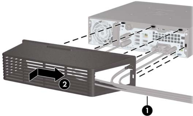
Figura 2-21 Instalación de una Cubierta para Puerto
