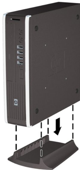
Figura 2-7 Colocación de la Computadora en la Base
