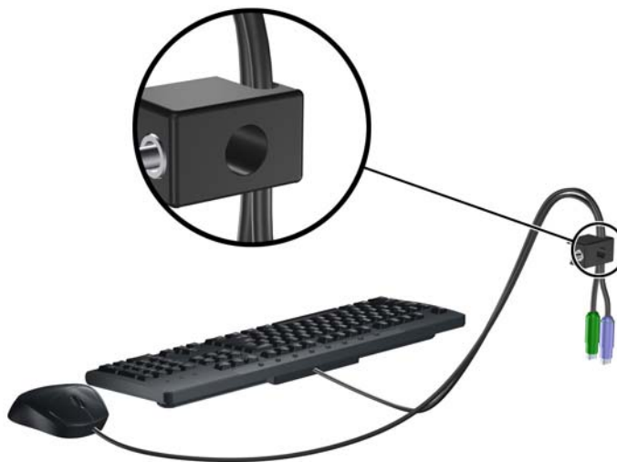
Obrázek C-5 Protažení kabelů klávesnice a myši
