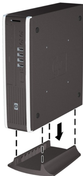
图 2-7 将计算机放到底座上
