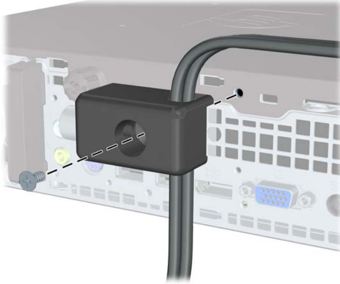
图 C-6 将钳锁固定到机箱上
