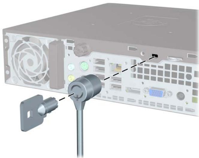
圖示 C-2 已安裝連接埠外蓋時安裝纜線
