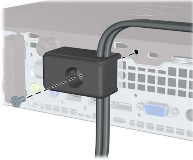
4. 將安全纜線尾端的插銷插入鎖中 (1)，並按下按鈕以嚙合鎖 (2)。使用鉗夾鎖提供的鑰匙，來解開鉗夾鎖。
