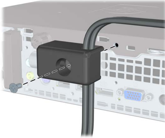
그림 C-6 새시에 잠금 장치 부착
