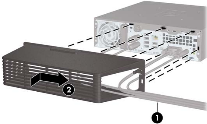
그림 2-21 포트 덮개 설치
