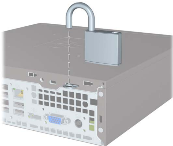
Attēls C-3 Slēdzenes uzstādīšana
